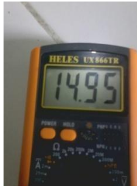
Gambar 4.8 Keluaran tegangan dari catu daya <15 Vdc
