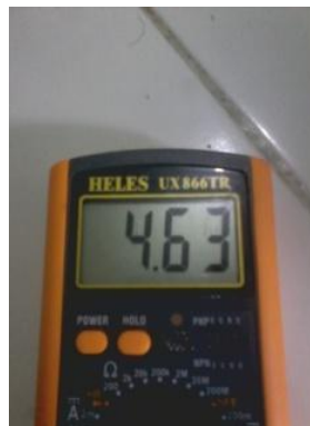
Gambar 4.8 Keluaran tegangan dari catu daya <15 Vdc
